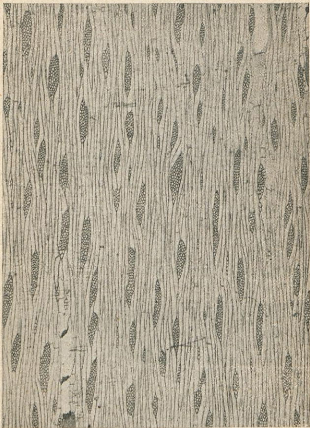
Fig. 18. — SECTION LONGITUDINALE TANGENTIELLE D'UN BOIS D' Evodia sutchuenensis Dode (Rutacées), avec rayons assez larges et peu élevés, non étagés. (Grossissement : 30 diam.)
