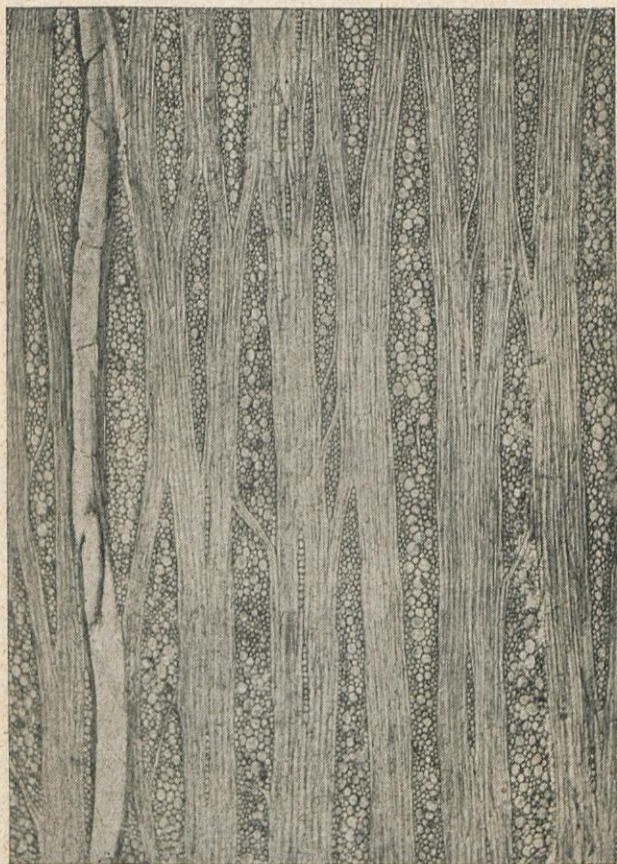
Fig. 22. — SECTION LONGITUDINALE DE BOIS DE Polyalthia jucunda F. et G. (Anonacées) de l'Indochine, avec rayons hétérogènes très grands. (Grossissement : 30 diam.)
