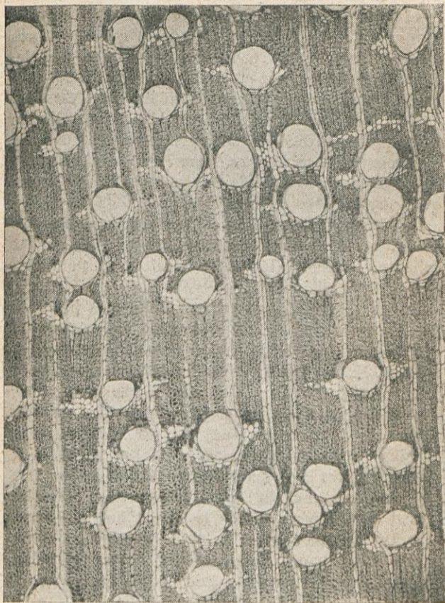
Fig. 28. — BOIS DE Dilobeia Thouarsii R. et S. (Protéacées) avec vaisseaux entourés en partie seulement par le parenchyme ligneux. (Grossissement : 30 diam.)
