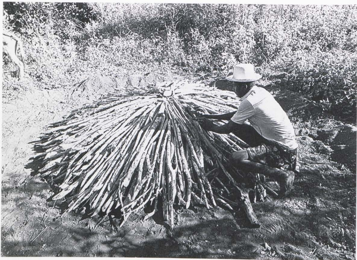
De la construction du four à charbon de bois ...
