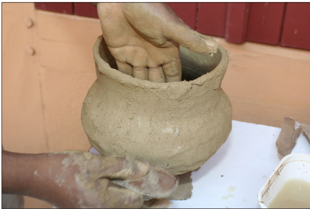
Figure 3 Maintien de la paroi en plaçant la main à l'intérieur du pot
