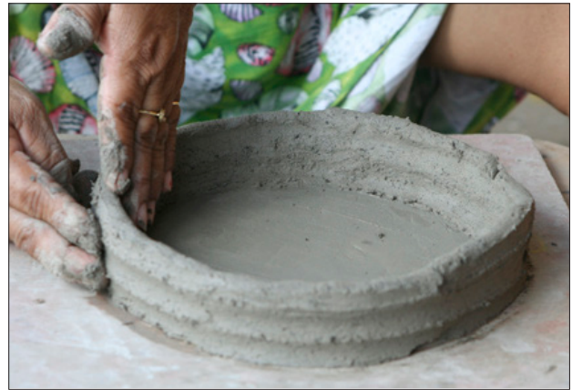
Figure 2 Montage du premier colombin
