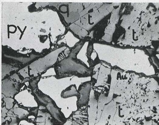
Fig. 15. — Section polie (LNx100), montrant un filonnet de pyrite (Py) recoupant des cristaux de tourmaline (t). Deux plages d'or (Au) sont visibles en bordure de la pyrite. Les taches sombres en creux au centre de la photographie correspondent au comblement des trous de la section par la gomme-laque.
