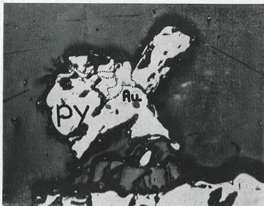
Fig. 18. — Section polie (LN×100) montrant une plage de pyrite (py) et d'or (Au) dans une cavité de minéral. La cavité est remplie par de la gomme laque (rayée, occupant le pourtour de la photographie). L'or remplit les fractures de la pyrite, qu'il corrode (Le contour des plages d'or est limité par un pointillé).
