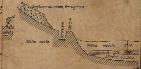
Fig. 8. Coupe à 200m en aval de l'Etablissement central (Double conglomérat)
